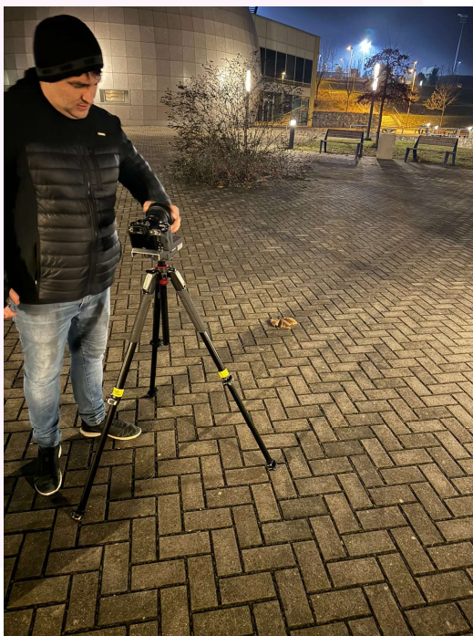
Pohled na instalaci měřicího zařízení a v pozadí jeden z hlavních zdrojů záření – světlomety na nasvětlení přilehlého sportoviště. Na zemi jsou patrné stíny vržené od hlavních zdrojů světla. Záznam z kontrolního laboratorního luxmetru
